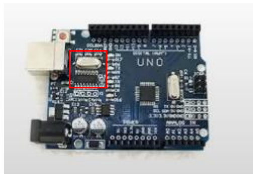
Arduino Uno compatible con Chip interface USB CH340 Compatible con el original
